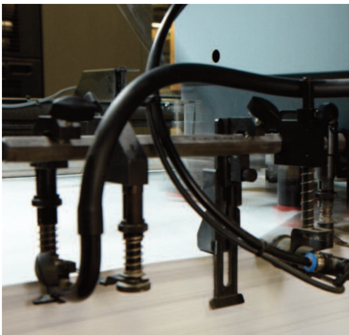
Elektrostatik führt zu Problemen im Materialdurchlauf.
