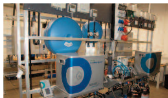
Die Draabe-Laborwerkstatt dient der Full-Service-Wartung zur Demontage, Prüfung, Reinigung inklusive Desinfizierung und dem Austausch von Einzelteilen sowie zur Mitarbeiterschulung.
