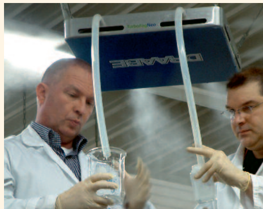
Qualifizierte Probenahme an der Systemgrenze zum Raum
